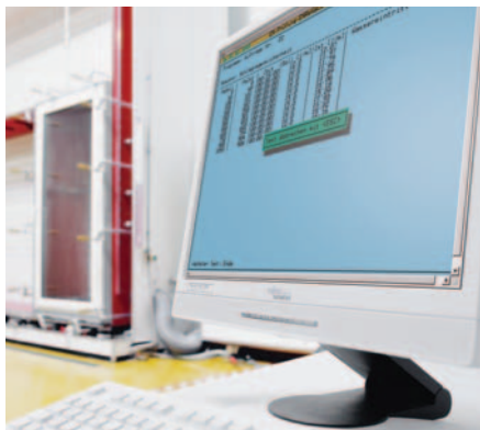
Testarea etanșeității la ploaia torențială
