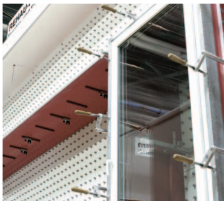
Echipament de testare pentru presiunea vântului
