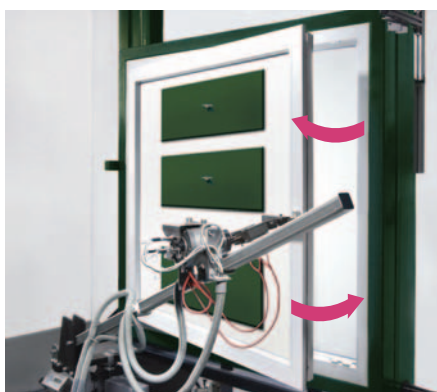
Echipament pentru testarea ferestrelor la solicitări intense
